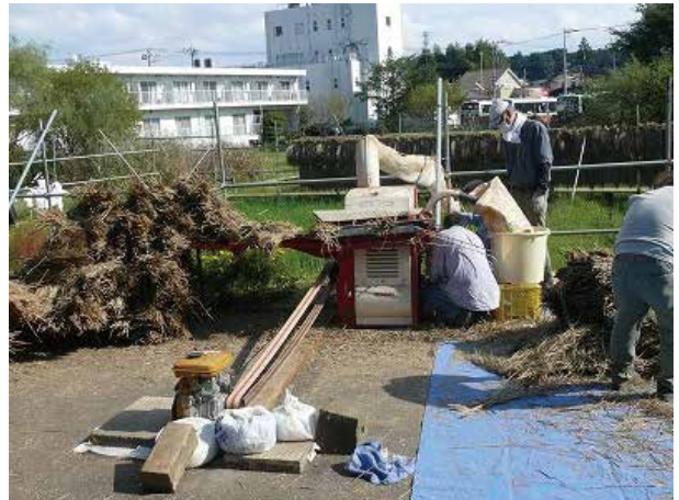
手前が発動機、ベルトで脱穀機を回します (粃が詰まって掃除中)
